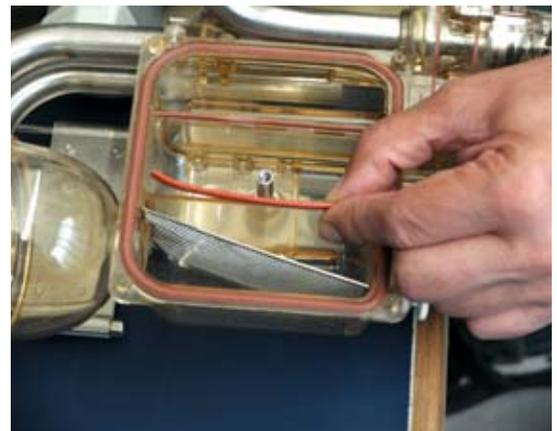
Die Dichtung vom Elektronikteil (li) bleibt schon mal am Fluidgehäuse (re) kleben. Einfach zurückstecken und aufpassen, dass sie nicht verloren geht.
