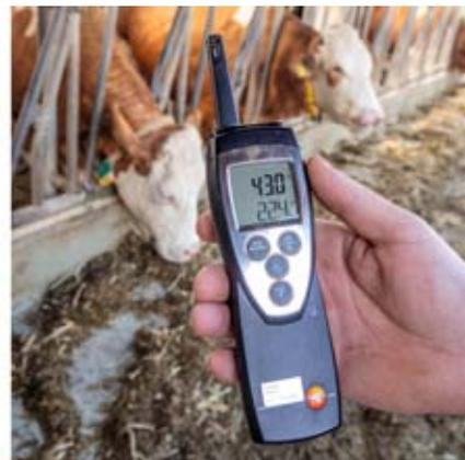
Vergleich Altgebäude mit Offenfrontstall: Wenig Wärmeeintrag aber hohe Luftfeuchte durch den geringen Luftaustausch.
