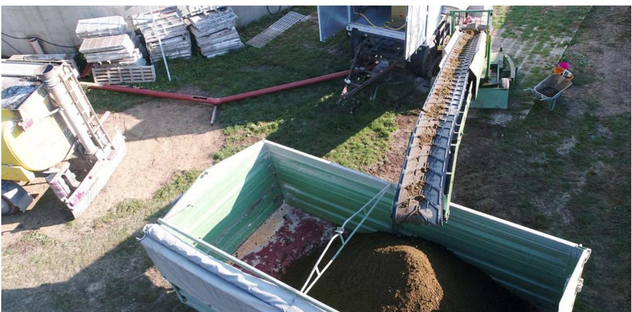
**Die Feststoffphase kann nach der Trennung einfacher und schneller abtransportiert werden.**
