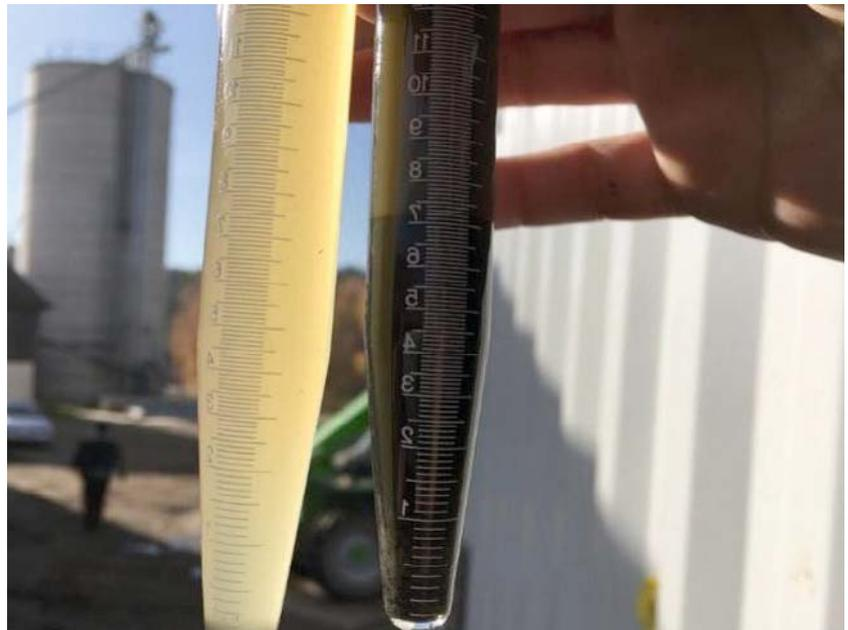
**Der Vergleich: Die flüssige Phase nach der Separation im Vergleich mit der unverarbeiteten Gülle (rechts).**
