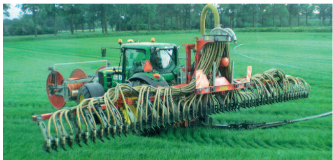
Großes Gerät: Gülleausbringung mit Schleppschlauch direkt aus der Güllegrube.
